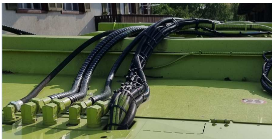
Bild: Öl- und Stromversorgung Fahrzeug der Kehrriechabfuhr
